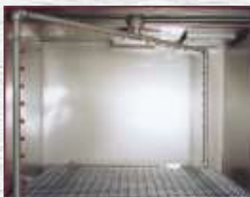
(Standard) Rotierendes Düsenrohrsystem
